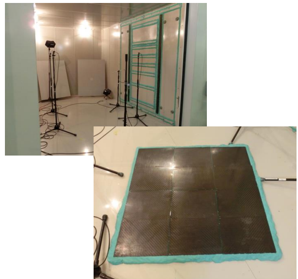
図 10 無響室内部と吸音パネルの設置状況
