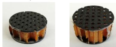
図 6 NC 加工で切出したインピーダンス試験片
