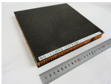
図 5 接着組立した吸音パネル(孔径 2mm)
