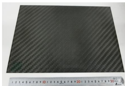
図 3 ブラスト加工した CFRP 多孔板(2.0mm 径)
